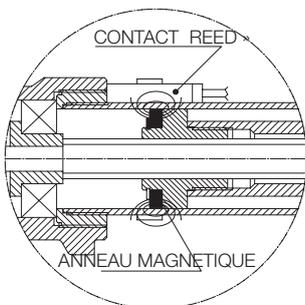
Le champ magnétique de l'anneau monté sur l'écrou de la vis actionne le contact « REED » du relais fixé par un collier sur le tube de protection de l'actionneur.
